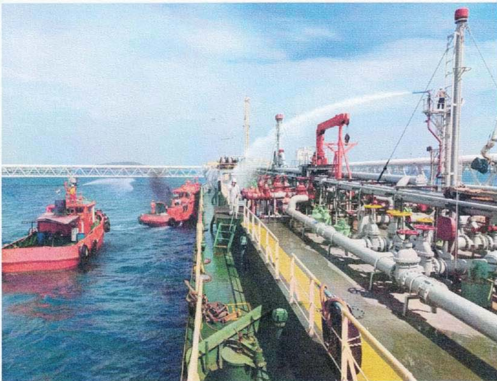
STT 18 ฉีดน้ำจาก Fire Monitor บนท่าและเรือทัก ช่วยฉีดน้ำดับเพลิงบริเวณห้องเก็บของหัวเรือด้านซ้าย
