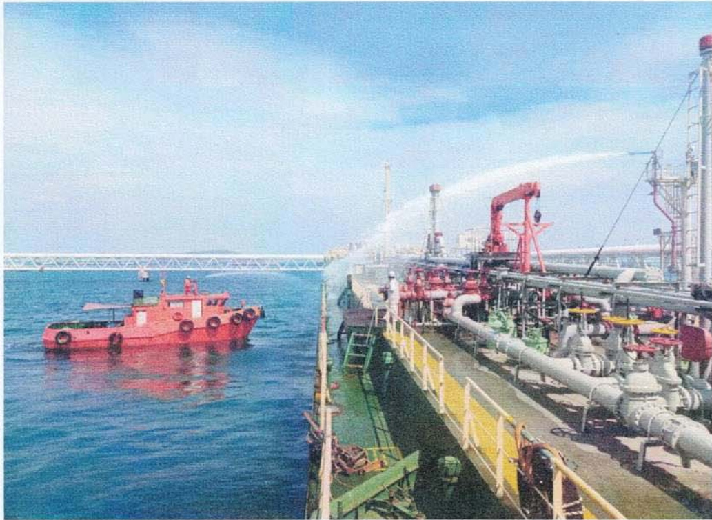
STT 17 ฉีดน้ำจาก Fire Monitor บนท่าและเรือทัก ช่วยฉีดน้ำดับเพลิงบริเวณห้องเก็บของหัวเรือด้านซ้าย
